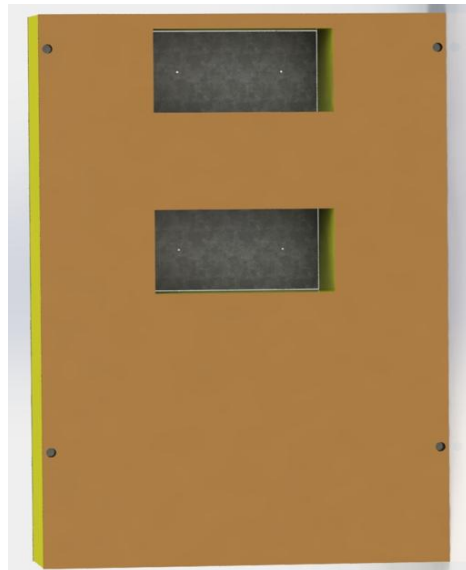
Рис. 7.1.2 Расположение шаблона (поз. 2 из комплекта поставки) на внутренней стенке с уличной стороны кондиционируемого помещения.
