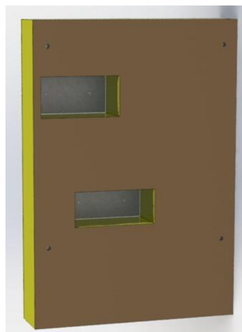
Рис. 7.1.4 Расположение шаблонов (поз. 3 и 4 из комплекта поставки) на внутренней стенке с уличной стороны кондиционируемого помещения.
